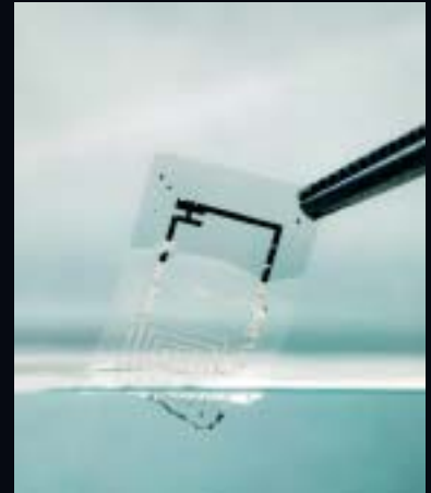
Zirkuitu elektroniko bat, uretan desegiten. ARG.: © BECKMAN INSTITUTUA; ILLINOISEKO ETA TUFTS UNIBERTSITATEAK.
