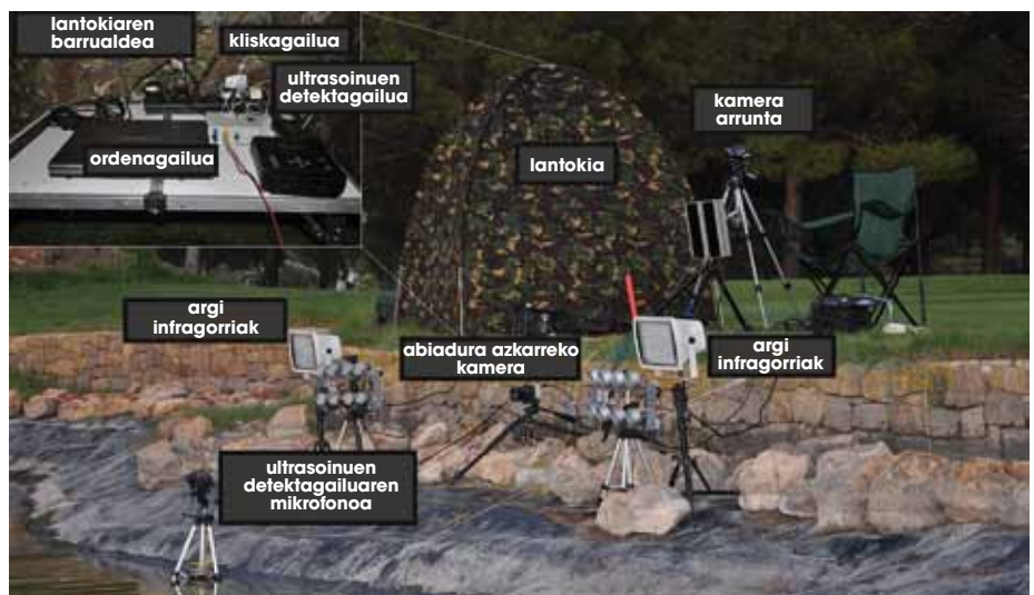
3. irudia. Esperimentuak egiteko erabilitako tresneria: abiadura azkarreko kamera (1.000 fotograma segundoko), argi infragorriak eta ultrasoinuen detektagailua, besteak beste.
