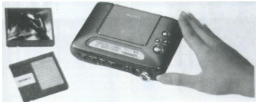
Diskoa, funtsean, disko optikoa da, baina geruza magnetiko bat erantsi zaio. Beraz irakurgailuak laser-buru bat izateaz gain buru magnetikoa du. Funtzionamendu-oinarria, geruza magnetikoak, berotzen denean, duen desmagneti-
