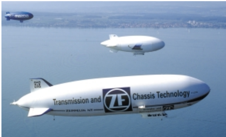
Zeppelin NTak aluminio- eta karbono-zuntzez egindako barne-egitura zurruna du eta gaur egungo baloi gidaturik handiena da (75 m). Atzeko baloi gidatuak barne-egiturarik gabeko 'blimp' txikiagoak dira.
