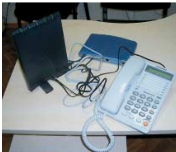
Ezkerreko argazkiko antenako objektu zuria da WiMAX hartzailea. Eskuinean WiMAX modema, rooterra eta VOIP telefonoa.
