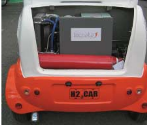
H2CAREN ihes-hoditik ur-lurruna igortzen da, eta maletategian hidrogeno-botila bat du, ibilgailuak ibiltzeko behar duen elektrizitatea ekoitziko duen erregai-pila elikatzeko.
