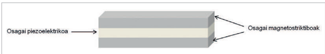
2. irudia. Sandwich-itxurako konposite magnetoeléctrikoa. Osagai magnetostruktiboak material piezoelektrikoaren bi aldeetan itsastan dira.
