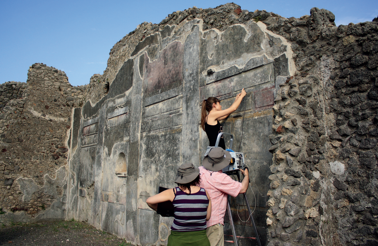
Marcus Lucretiusen alboan dagoen Obonius etxeko horma-margoetan zuzeneko neurketak egiten, Raman espektrometroa erabilia, zunda bidez.
