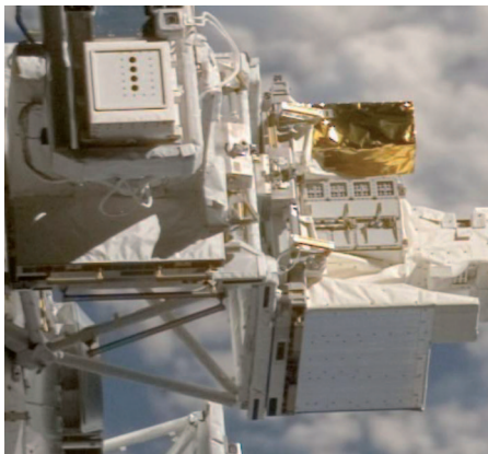
EXPOSE-E plataforma, ISSaren Columbus moduluan.
