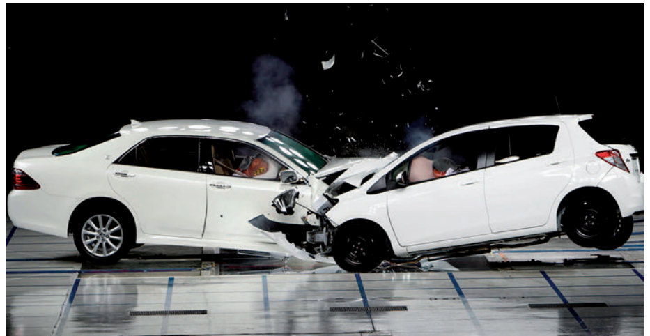
3. irudia. Demagun bi autok elkarrekin talka egiten dutela eta itsatsita geratzen direla. Nola jakin norantz mugituko diren talkaren ondoren? ARG.: TOYOTA.
