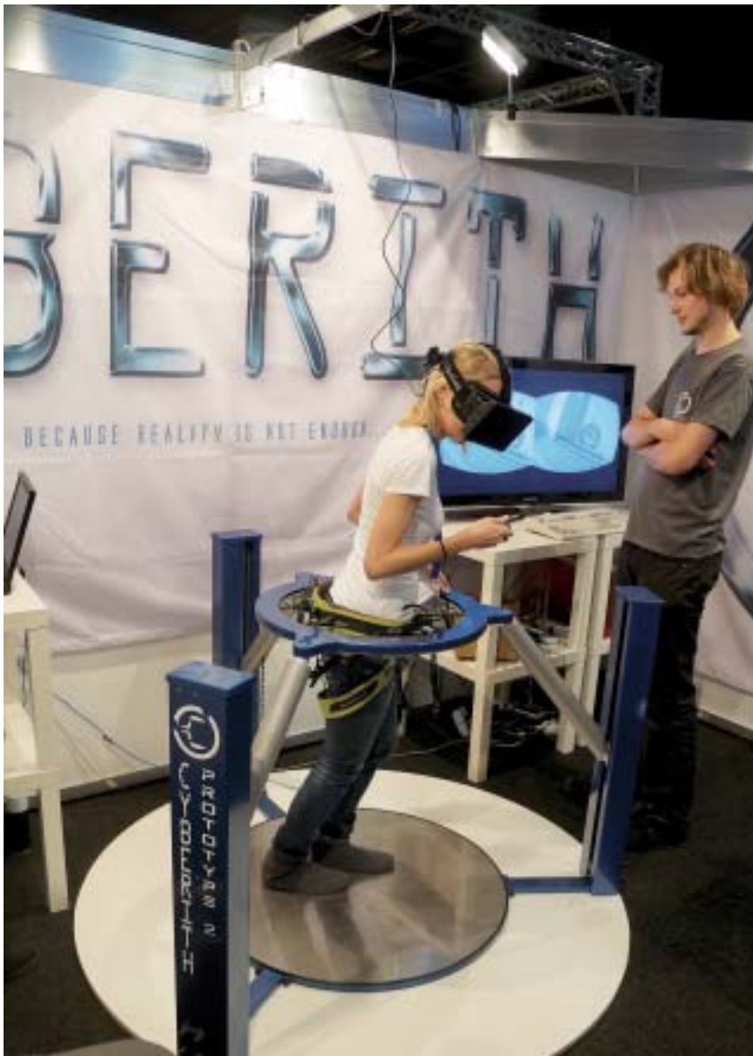
Hainbat sistema konbinatuta (irudian, Oculus Rift eta Cyberith Virtualizer prototipoak) errealitate birtualeko benetako sentsazioa lor daiteke. ARG.: OLEG2525/CC-BY-SA.
