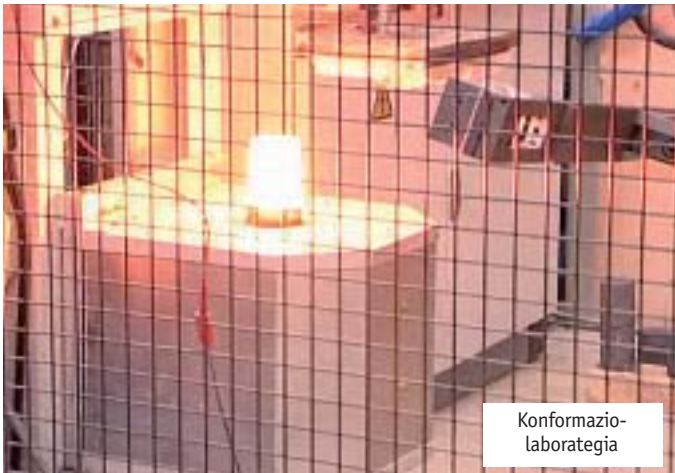
Altzairuzko totxoa 1.400 °C-ra berotzen da lehenengo (ezkerrean). Ondoren, kolpe bakarrean lantzen dute pieza prentsan (eskuinean). ARG.: MONDRAGON UNIBERTSITATEA.
