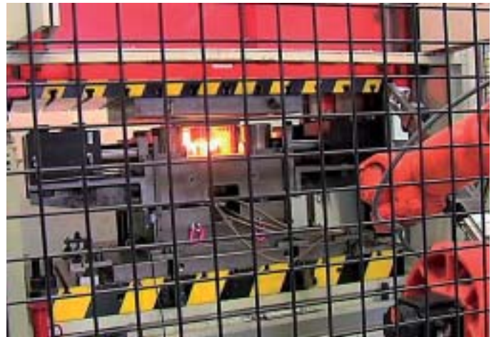
Altzairuzko totxoa 1.400 °C-ra berotzen da lehenengo (ezkerrean). Ondoren, kolpe bakarrean lantzen dute pieza prentsan (eskuinean). ARG.: MONDRAGON UNIBERTSITATEA.
