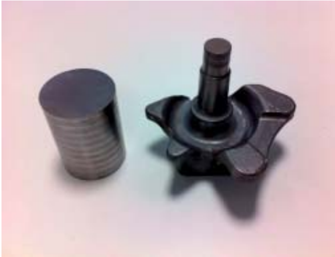
Ezkerrean totxoa, eta ondoan pieza bukatua. Pieza auto-modelo jakin bateko atzealdeko ardatzean jartzen da, disko-balaztari eusteko (irudiko pieza morea). ARG.: MONDRAGON UNIBERTSITATEA.
