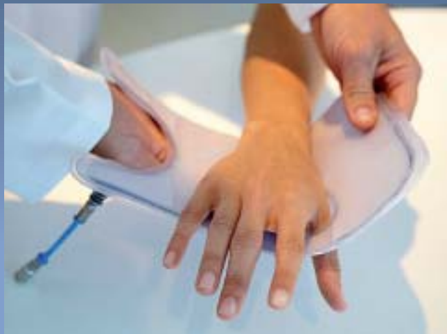
Varstiff materiala edozein gorputz-ataletan jar daiteke bigun dagoela, eta hutsa egitean igeltsua bezain gogor gelditzen da. ARG.: © TECNALIA.
