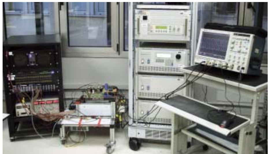
EHUko APERT ikerketa-taldeko laborategian garatutako potentzia-bihurgailu matrizial hutsegite-tolerantziailearen plataforma esperimental. Ezkerretik eskuinera: kontrolaz arduratzen den RT-Lab eMEGAsim gailu digitala, MCaren prototipoa, iturri eta karga programagarriak eta osziloskopioa. ARG.: © EORTA IBARRA/EHU.
