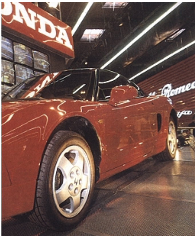
Honda etxeak NSX deituriko kirol-automobilaren bertsio berezi bat kaleratu du. Ohizko bertsioan aluminio-portzentaia ez zen % 7tik gora igotzen, baina pisua jaisteko asmoz, karrozerian aluminioa erabiliz material honen portzentaia % 31ra igo zen, horrela karrozeriaren pisua 140 kg jaitsiz.
