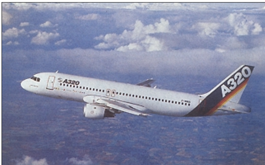
Airbus 320 hegazkin europarra, ohizko erresistentzia handiko aluminio-aleazioez gain, Al/Li aleazio berriez ere hornituta dago.
