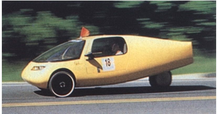
Gaur egungo automobiletan garrantzi handikoa da karrozeria "koskarik gabekoa" izatea, koefiziente aerodinamiko txikia lortzearen.
