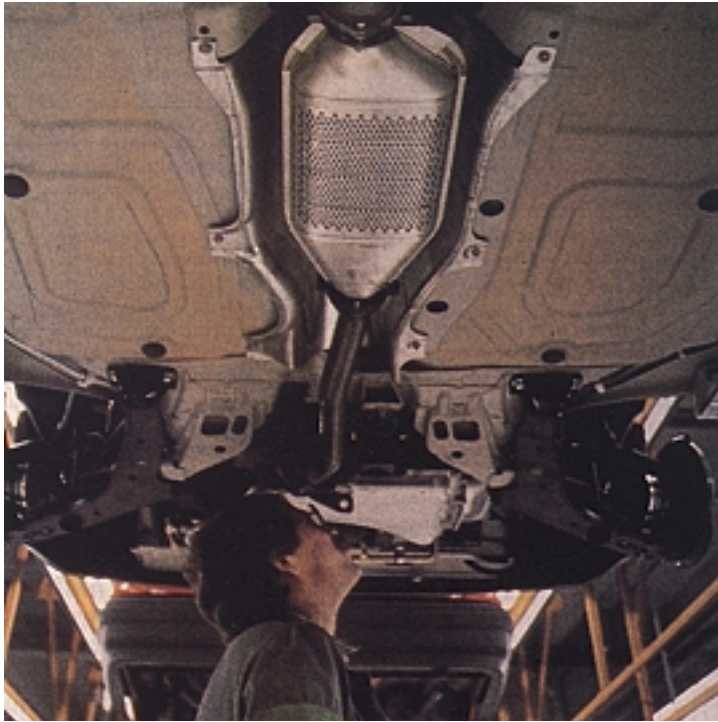
Pote katalitikoari esker, ihes-gasetako karbono (II) oxidoa eta nitrogeno (II) eta (IV) oxidoak deuseztu egiten dira.
