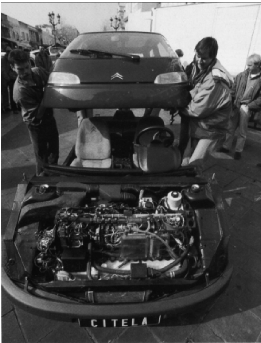
Frantziako PSA etxeak iazko urrian "Citela" izeneko automobil elektrikoaren prototipoa aurkeztu zuen. Txasisa metalikoa du, baina karrozeria guztia plastikoz egina. Negurako itxia edo udarako irekia da automobila.
