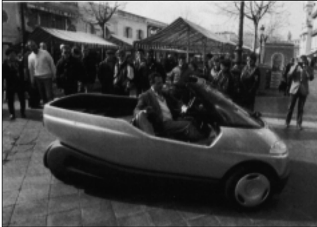
Frantziako PSA etxeak iazko urrian "Citela" izeneko automobil elektrikoaren prototipoa aurkeztu zuen. Txasisa metalikoa du, baina karrozeria guztia plastikoz egina. Negurako itxia edo udarako irekia da automobila.
