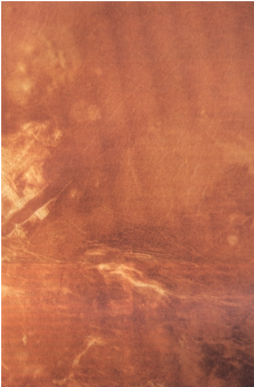
Radarren bidez lortutako irudietan, argitasunaren ezberdintasunak gainazalaren maldaren eta zimirtasunaren arabera dira. Lautadak ilunago agertzen dira eskualde malkartsuak baino.
