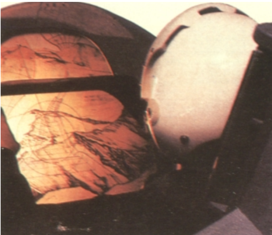
Gauze ikusteko kaskoa erabat garatu arte, pilotuak oraingoz aparteko pantaila batean jasotzen du informazioa. Paisajearen irudien gainean, irudi sintetikoak ere ezarrita ditu.
