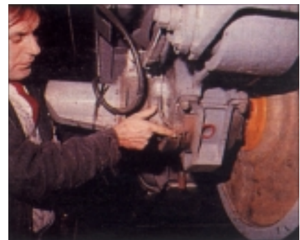
Sigi-sagaren aurkako 3 motelgailuk (ikus geziak) kontrolatzen dute bogie bakoitzaren albo bakoitzean ibilgailu osoaren "dantza", 3 kaptadore elektrikok neurtuta. Horrek damaio segurtasuna 500 km/h-ko abiaduraz goitik arriskurik gabe zirkulatzeke.
