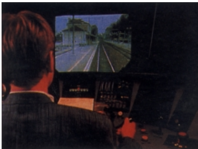
Mekanikariak (gidariak) hegazkin-pilotuek bezala, simulatzaile informatiko batean hartzen dute informazioa, gidari-postuan erreproduziturik. Irudiak, paisaia eta erreibidea agertzen ditu bideodiskoak erregistratutako benetako irudietatik abiatuta. Gainera, panelak, seinaleak, etab. mahai-azalean...
