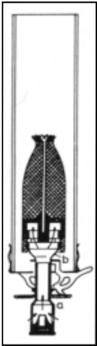
Auer erregailuaren irudi eskematikoa. Auer lanpara goritasuneko da. Gasak ez du argia sortzen; gasaren errektuntzak beroa sortzen du eta zorroa berotzen. Zorroak, goritzen denean, argi-erradiazioak igortzen ditu.
