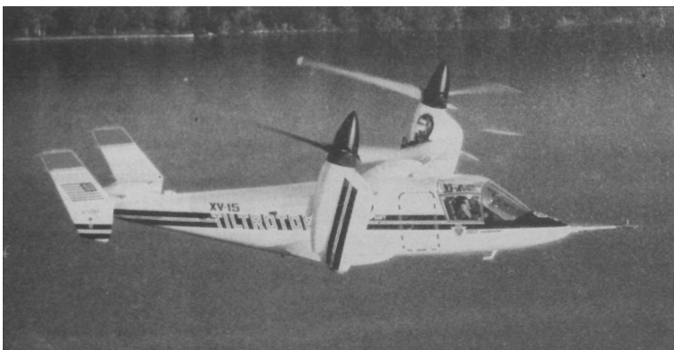
Bell Helicopter etxearen XV-15A eredu bertikalki igo eta horizontalki desplazatzeko bere errotoreak baskulatu ari da.
