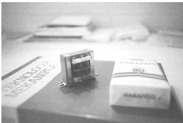
Elektronika-praktiketan erabilitako elikadura-transformadorea. 220-127/12 volt. Dimentsioak: luzera: 45 mm; zabalera: 32 mm; altuera: 40 mm. Pisua: 190 g.
