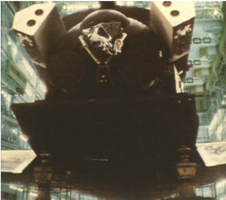
Atzeko partea. Motore nagusiak ederki ikusten dira. Motoreek bi aldiz piztu ziren: lehenbizi jaurtigailuen lehenengo bi urratsak itzali ondoren orbitara heltzeko eta gero orbita zirkular bihurtzeko. Etorreran motore hauek segurtatzen dute balaztaketa.
