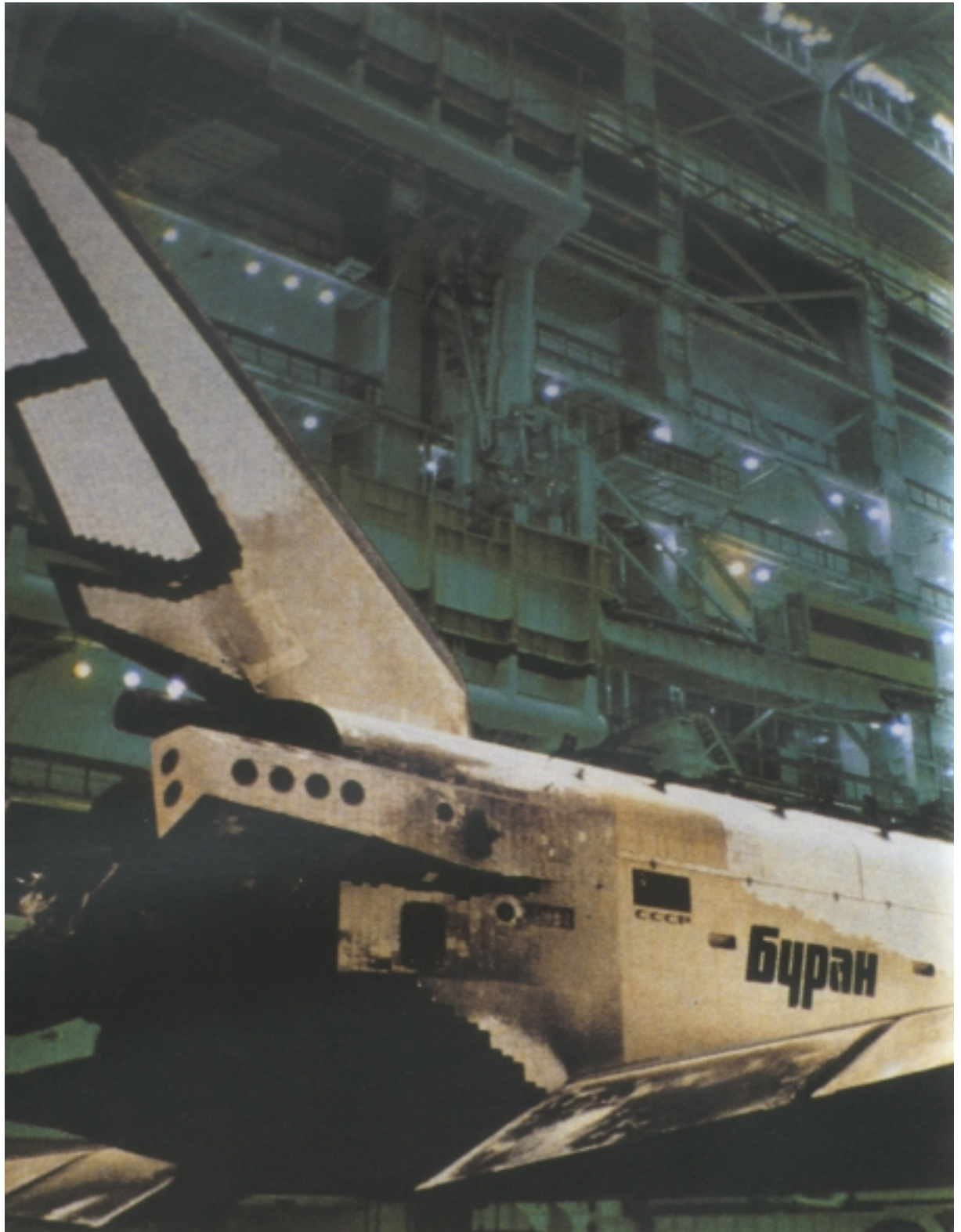
Buran transbordadorea Baikonur-eko hangarean Lurrera itzuli eta zenbait egun geroago. Atmosferara birsartzean 1.600 °C-raino berotzen da eta gero hori jasan ahal izateko zeramikazko 38.000 lauzatkoz estalita dago. Lauzatxo zuriek koartzoa dute eta beltzek karbono-konposatuak. Atzeko partean ikusten diren erredura-arrastoak lurrutzeko koheteen kedarrezkoak dira eta ez birsartetan sortutako erredurak.
