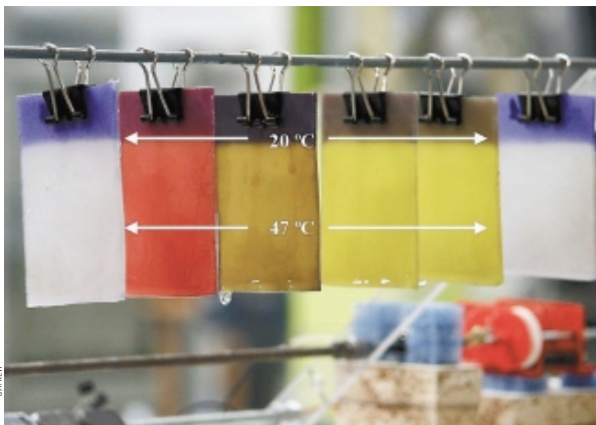
Material termokromikoak. Temperatura-aldaketek kolore desberdinak eragiten dituzte.
