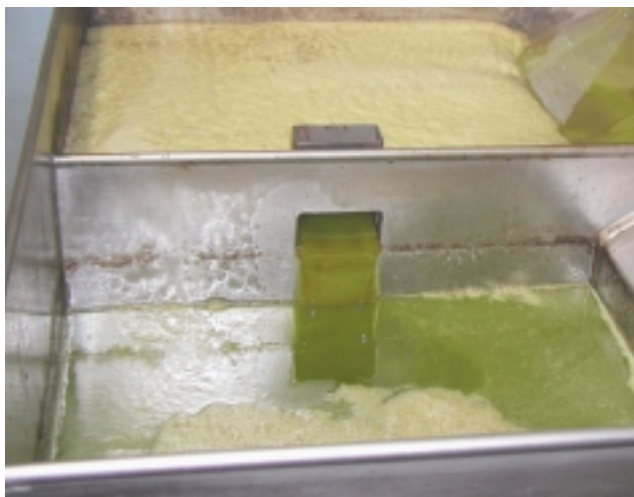
Zentrifugatzaileratik ateratzen den olioak ur pixka bat eta solidoen arrastoak ditu. Horiek kentzeko, dekantagailuetan sartzen da olio.
