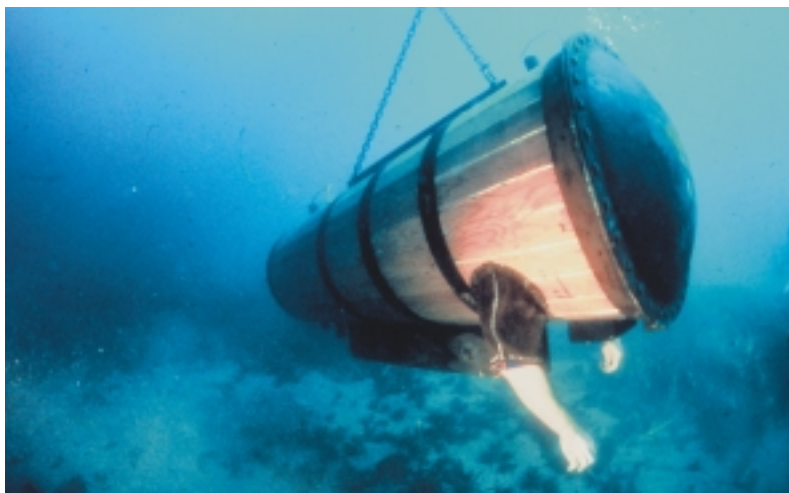
John Lethbridge-k 1715ean erabili zuen ereduaren erreplika. Ur-azaletik aire konprimitua jasotzeko modua ere bazuen zilindroak.
