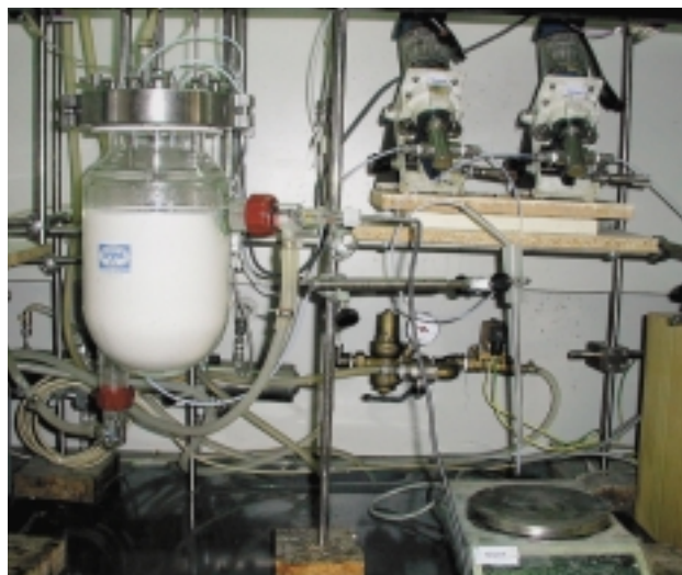
Emulsioan egiten diren polimerizazioetarako erreaktorea.
