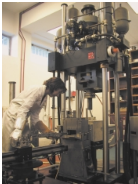
Kompresio-simulatzailerekin gai dira altzairua, edozein temperaturatan dagoela ere, bat-batean izoztu eta mozteko.
