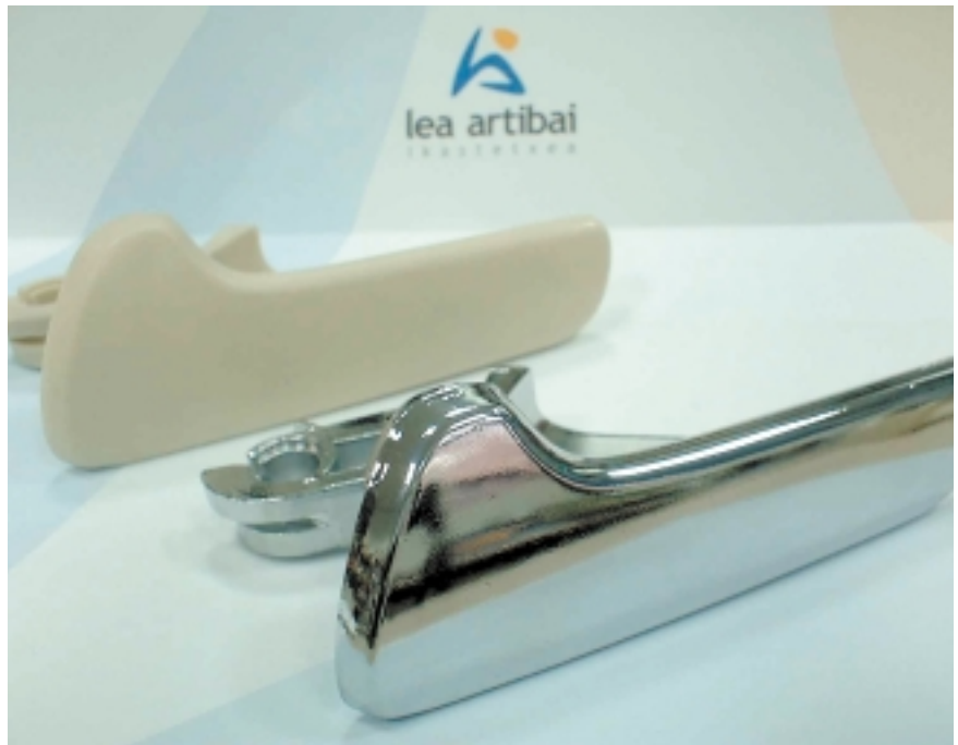
Auto baten heldulekua, kromozko bainua eman aurretik eta ondoren. Plastikozko bihotza dute heldulekuek.
