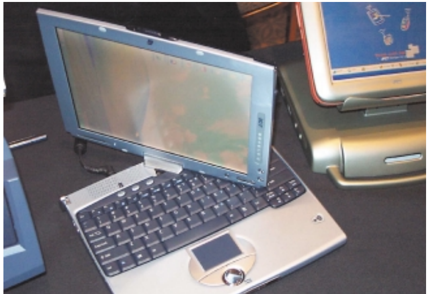
Toshibak diseinatu duen Tablet PCaren pantaila ardatz baten baitan biratzen da, aukeran, kaier-itxura edo ohiko ordenagailuarena hartzeko gisan.
