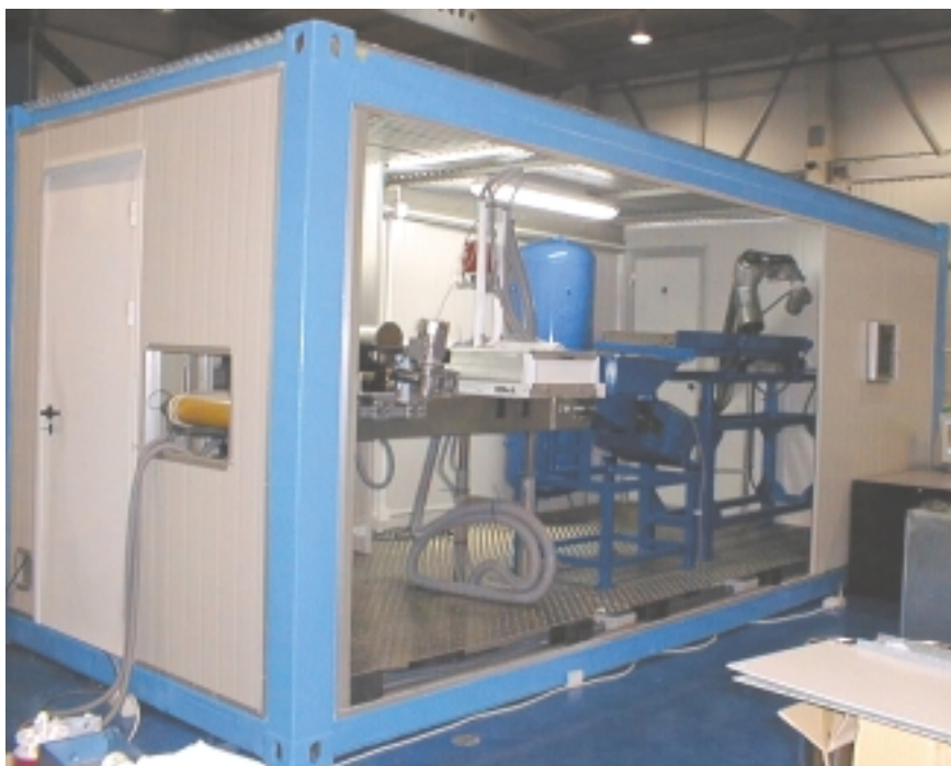
Kableen kobrea eta ezpurutasunak bereizteko sistema osoa edukiontzi baten barruan dago.
