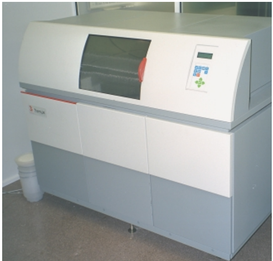
Argizarizko prototipoak egiteko inprimagailua.
