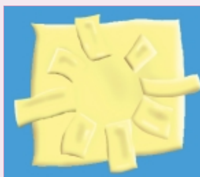
4. Argizarizko prototipoa, piezaren moldea egiteko aproposa.
