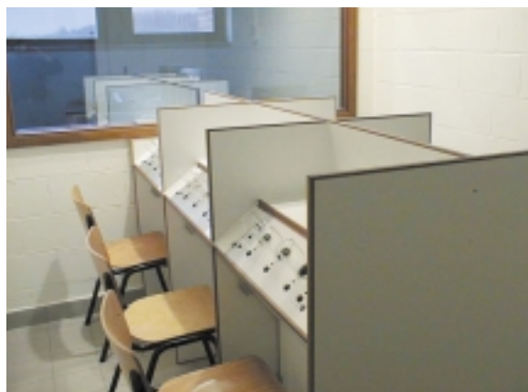
Laborategi olfatometrikoko bat. Aditu bakoitzak bi hodi ditu aurrean, eta usaina bietako edozeinetatik iritsiko zaio.
