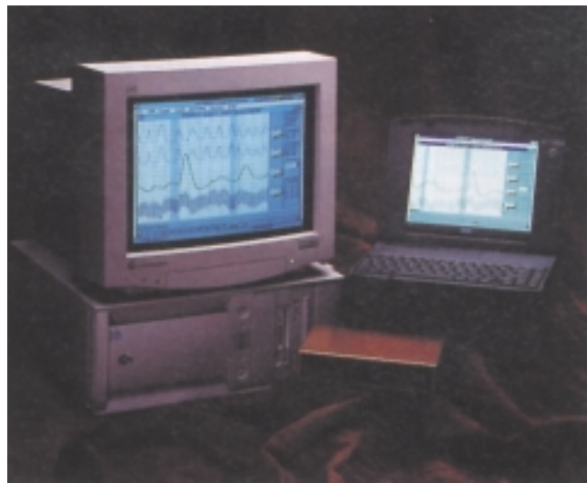
Poligrafo edo gezur-detektagailu honek pantailan erregistratzen ditu tentsioan, arnasean edo izerdian izandako aldaketak; baita emozio handiaren indizeak ere.
