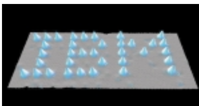
Xenon-atomoek IBM letren irudia osatzen dute nikel-azalaren gainean.
