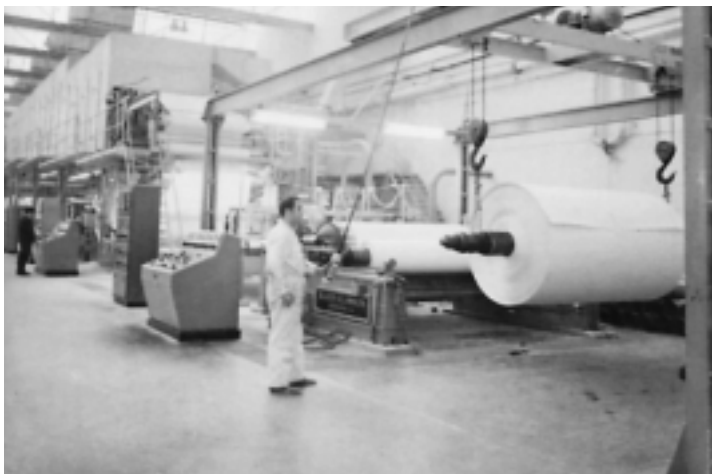
Argazki honetan ikus dezakegunez, papera fabrikazio-prozesuaren azken urratsean dago. Lehortu, lisatu eta prentsatu dute papera. Orain, zilindrotik atera eta neurri desberdinetako paper-bobinak egingo dituzte.
