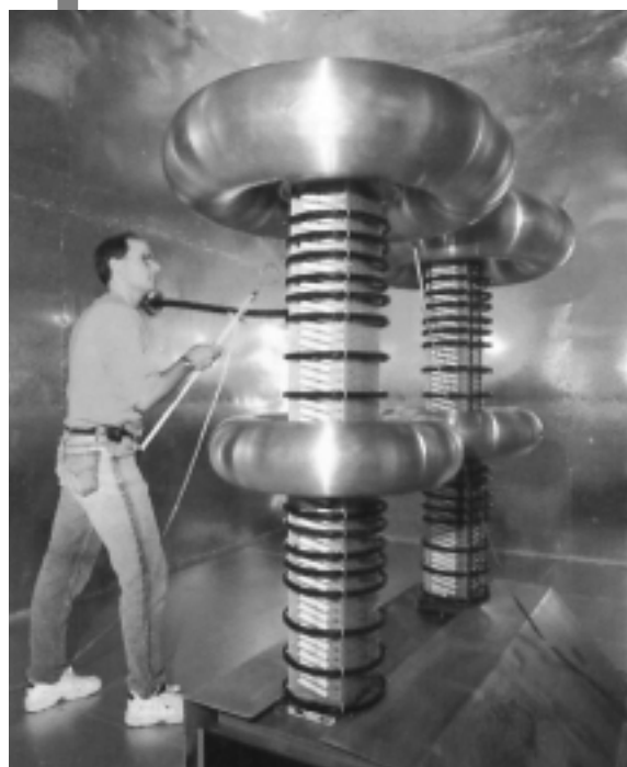
Virginiako Jefferson laborategian 500.000 voltetako sorgailu elektrikoaz intentsitate handiko eremu magnetikoa eratzen da laser izpia sortzeko.
