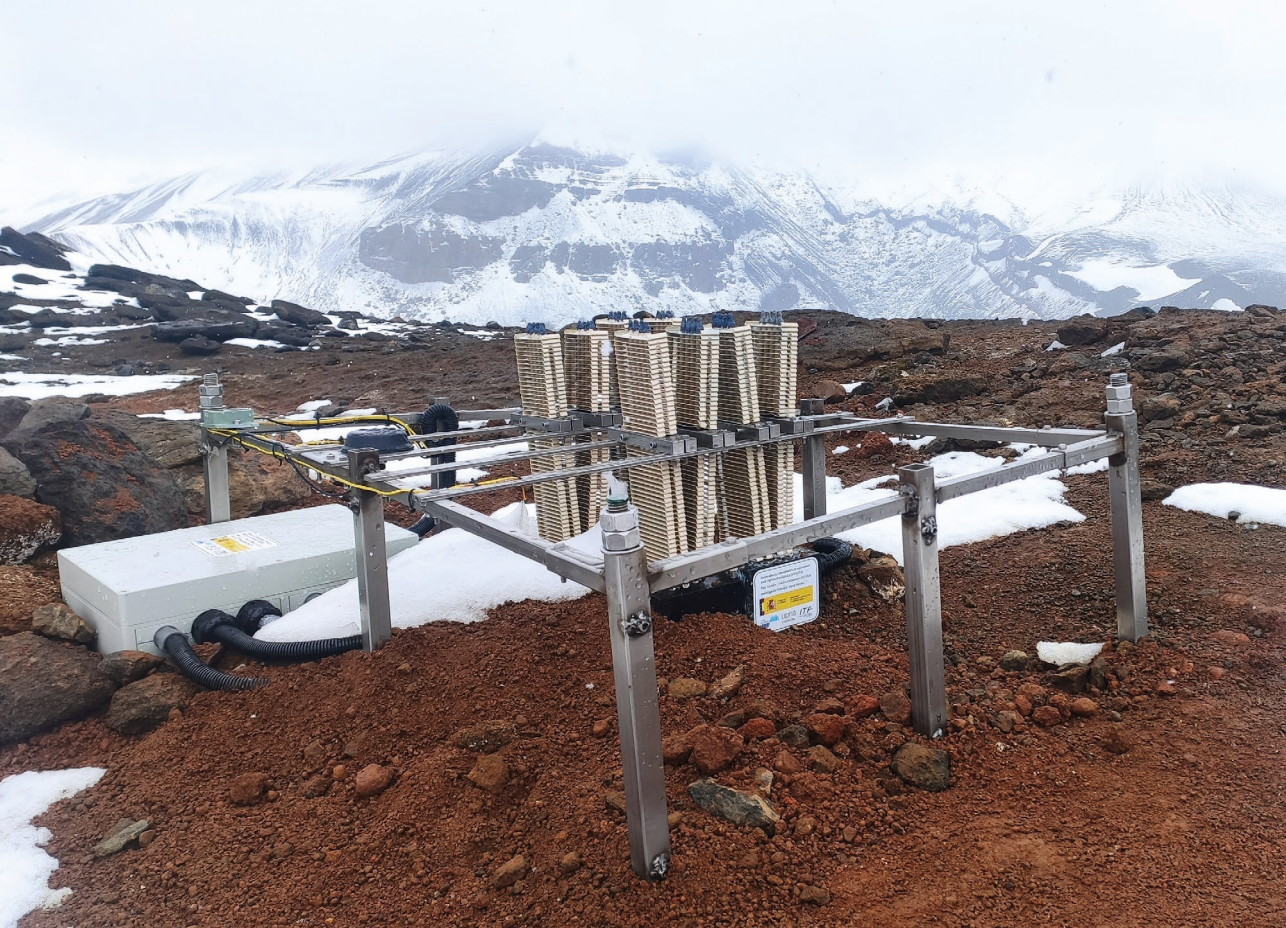
Antartikan instalatutako sorgailu termoelektriko geotermikoetako bat. ARG.: NUP.
