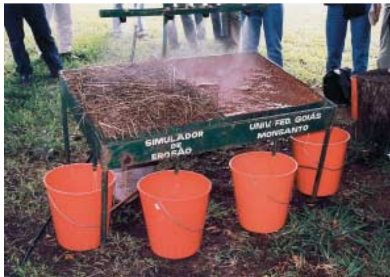
Brasilen egindako simulazio-proba, lurra estalita izateak higaduratik nola babesten duen ikusteko. Eskuin aldean, lurra biluzik dagoenean alegia, ur gehiago galtzen da eta arreak ateratzen da ezkerrean baino.
