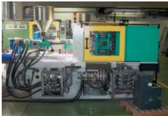
Materialen erresistentzia neurtzeko probetak sortzea da makina honen helburua.
