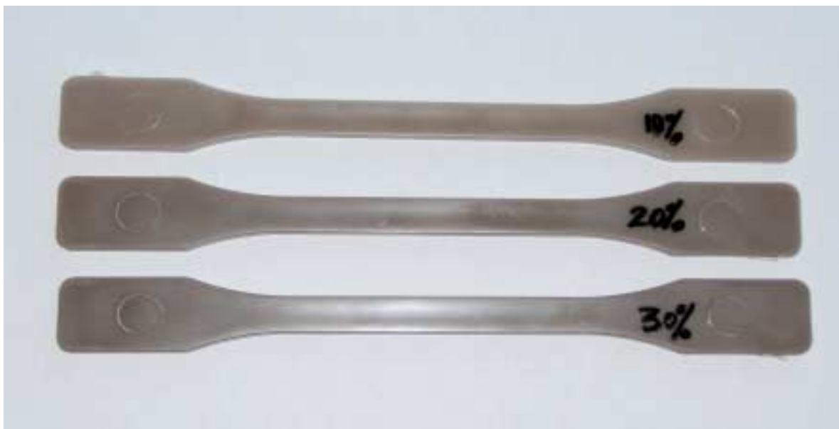
Anhidrita-portzentaje ezberdina duten polipropilenoazko probetak. Probeta horiek Gaiker IK4n ekoitzi ziren.
