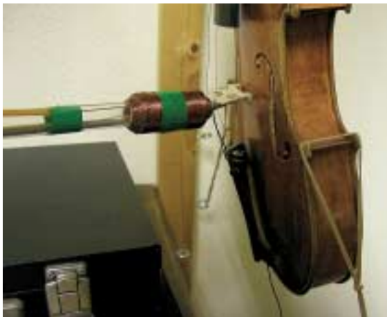
Zintziliek dagoen biola baten zubiak (ezkerrean) zein bibrazio transmititzen dituen jakiteko, maiztasunen analisia egiten zaio piezari (eskuinean).
