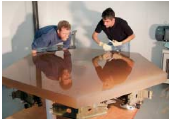
Zerodur izeneko materiala dielektrikoa da eta dilatazio txikia eragiten dio tenperaturak. Horrela, ez da errorerik sortzen argiaren islan.
