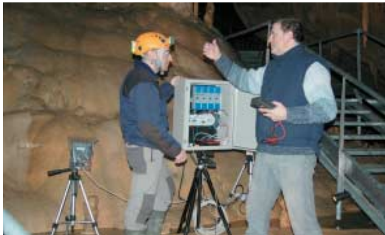
Mendukilon hiru estazio klimatiko dituzte. Sentsoreen bidez, arrokarren eta uraren temperatura, karbono dioxidoaren kontzentrazioa, hezetasun erlatiboa, eta presio atmosferikoa neurtzen dituzte.
