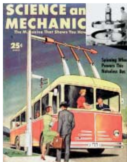
Girobusa: giroskopio batek propulstsatutako autobusa. Suitzan erabili zuten 1950eko hamarkadan, baina ez zen gidatzeko erraza.
