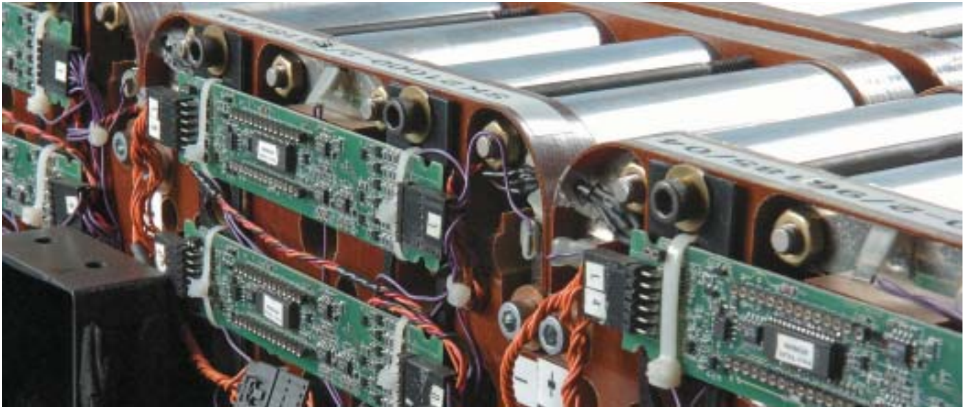
Litio-ioizko bateriak gaur egungo auto elektriko batean. Gailu elektroniko txikiengatik garatutako baterien egokitzapena dira. Horrelako sistemek, dagoeneko, auto batek hirian behar dituen adinako intentsitatea eta energia ematen dute; hala ere, hobekuntzak egin beharko dituzte bidaia luzeetan ere ondo funtzionatzeko.
