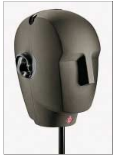
Belarrietan norabide orotako mikrofonoak dituen burua erabiltzen da holofoniak grabatzeko.
