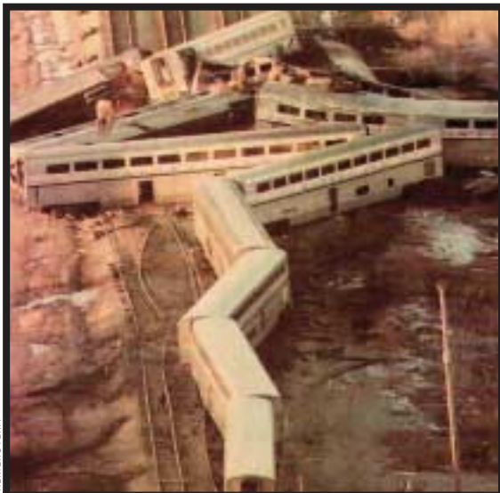
Tren klasikoetan bagoiak guztiz independenteak dira, eta horregatik gertatzen da akordeoi-efektua istripuetan.
