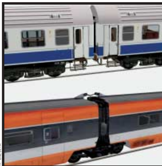
Tren klasikoaren goian eta tren artikulatua ezkerrean behean. Bogie -a goian.
