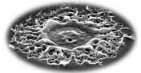
Karbonozko nanohodizko geruza batean arku elektriko bidez egindako kraterra, 16.000 aldiz handituta ekarketa mikroskopio elektroniko bat erabiliz. Eskala horretan, eragin handia dute interferentzia txikienek. ARGAZKIA: STEPHEN LYTH.
